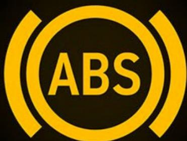
Se enciende al tener una frenada brusca o de emergencia, deberá apagarse al soltar el pedal de freno, si se queda encendido indica que hay una falla en el sistema ABS. También se enciende por alguna falla en el sistema de estabilidad.
