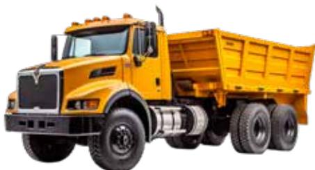
Estos camiones tienen una caja abierta con un mecanismo hidráulico que permite volcar el contenido, facilitando la descarga de materiales sueltos como arena, grava o escombros.
