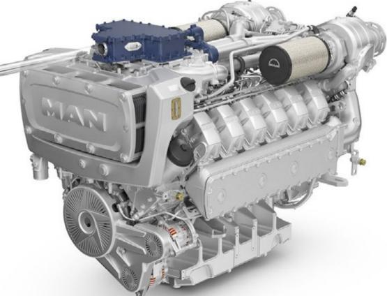
Un cambio importante, sin embargo, es el aumento del diámetro interior de 138 mm a 145 mm, mientras que la carrera se mantiene sin cambios en 176 mm. Esta modificación a una cilindrada mayor de 16,8 litros en comparación con los 15,3 litros del motor diésel MAN D3876 es necesaria dada la menor densidad de potencia de los motores de hidrógeno para alcanzar la potencia objetivo.
